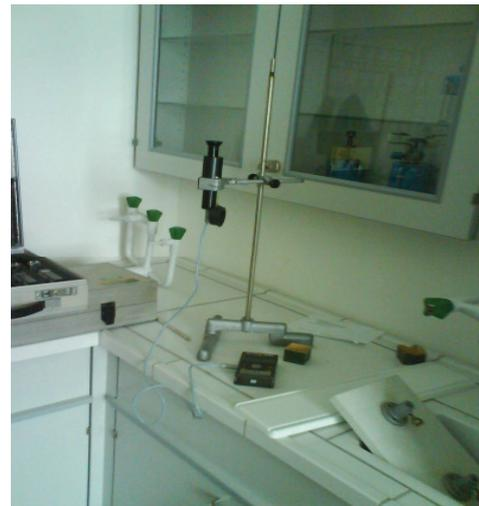
Bei diesem Okular handelt es sich um ein Spinthariskop das den radioaktiven Zerfallprozess von Alphastrahlen dem freien Auge sichtbar macht. Die radioaktive Substanz besteht größtenteils aus dem Alphastrahler Radium mit geringen Gammaanteil, welcher eine Halbwertszeit von 1600 Jahren aufweist.
